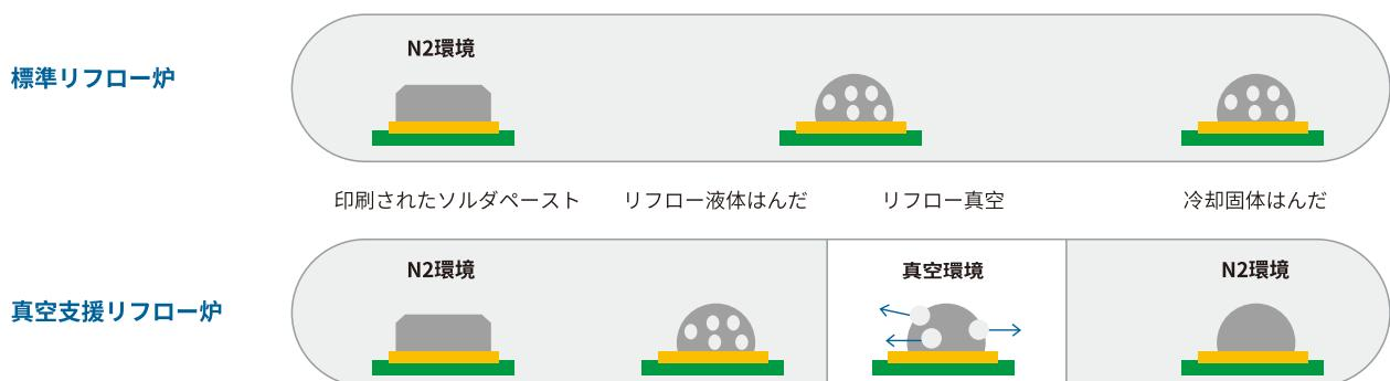
液体はんだ内の気泡は、圧力が低下するとサイズが大きくなります。
